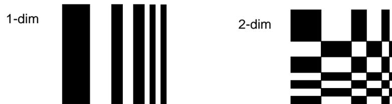
Abb. 6.5: Ein- und Zweidimensionale Implementierung einer Barkerserie für Markenerkennung bei der Elektronenstrahlithographie.
