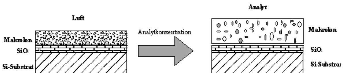
Abb. 22: Schichtmodell der Quellung.
