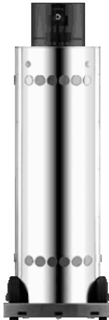
**Abbildung 1:** Kommerziell verfügbarer Überwachungsroboter Mosro 1. Der Roboter ist 25 kg schwer, 116 cm hoch und 30 cm breit. Im roten Kopf des Roboters ist das Kameraobjektiv zu erkennen. Im zylinderförmigen Körper ist unten und oben jeweils eine Reihe Ultraschallsensoren zu sehen. Die Infrarotsensoren sind im Fuß des Roboters montiert.
