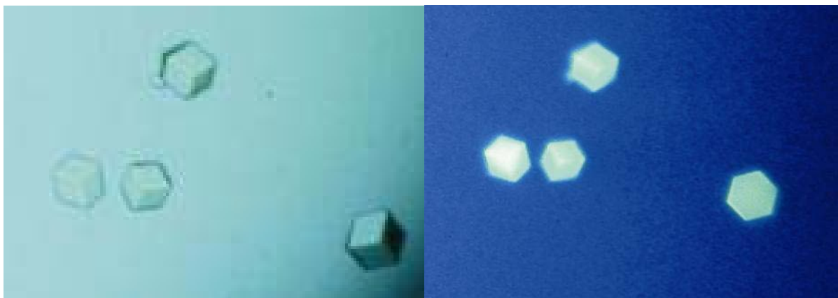
Abb. 15: Kristalle von Peptid AS 5-40 . Aufnahme bei Beleuchtung mit sichtbarem Licht (links) und ultraviolettem Licht \lambda = 360 nm (rechts). Die Kristalle waren kubisch mit einer Kantenlänge von ca. 0,1 mm. Unter UV-Licht ist die für Hefe-MT typische Fluoreszenz (bei der Aufnahme farblich verfremdet) zu erkennen.
