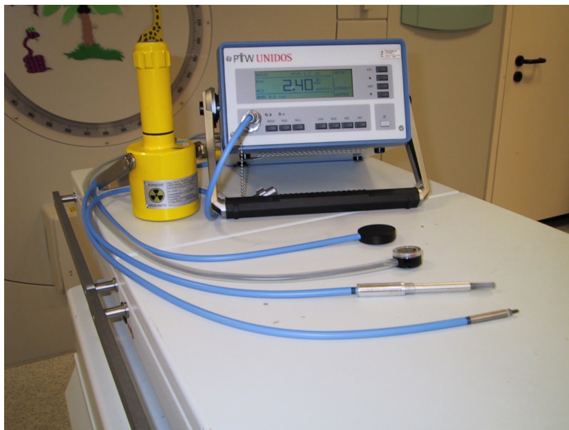
Abbildung 5.1: Auf diesem Bild sind Beispiele für die unterschiedlichen Bauarten von Ionisationskammern zu sehen. Im Hintergrund ist das in dieser Arbeit verwendete Elektrometer neben einer radioaktiven Kontrollvorrichtung zu erkennen.
