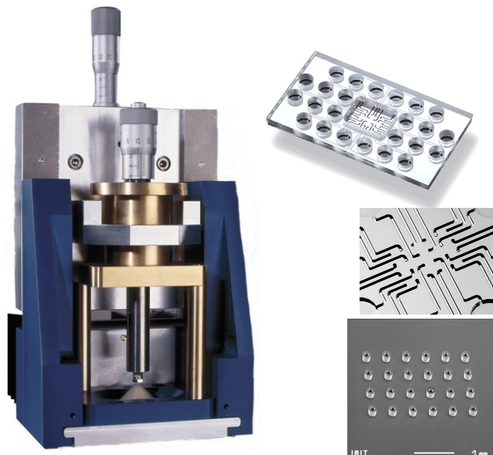
Abb. 17: Links: TopSpot ® -Druckmodul; rechts: 24-Medien-Druckkopf (oben), bei dem die Probenlösung über selbstbefüllende Kapillare (mitte) zum Düsenarray (unten) geleitet wird.
