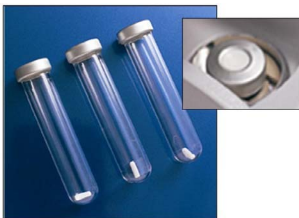
Abb. 4-29: Druckstabile Reaktionsgefäße (bis zu 20 bar) für die chemische Mikrowellensynthese.
