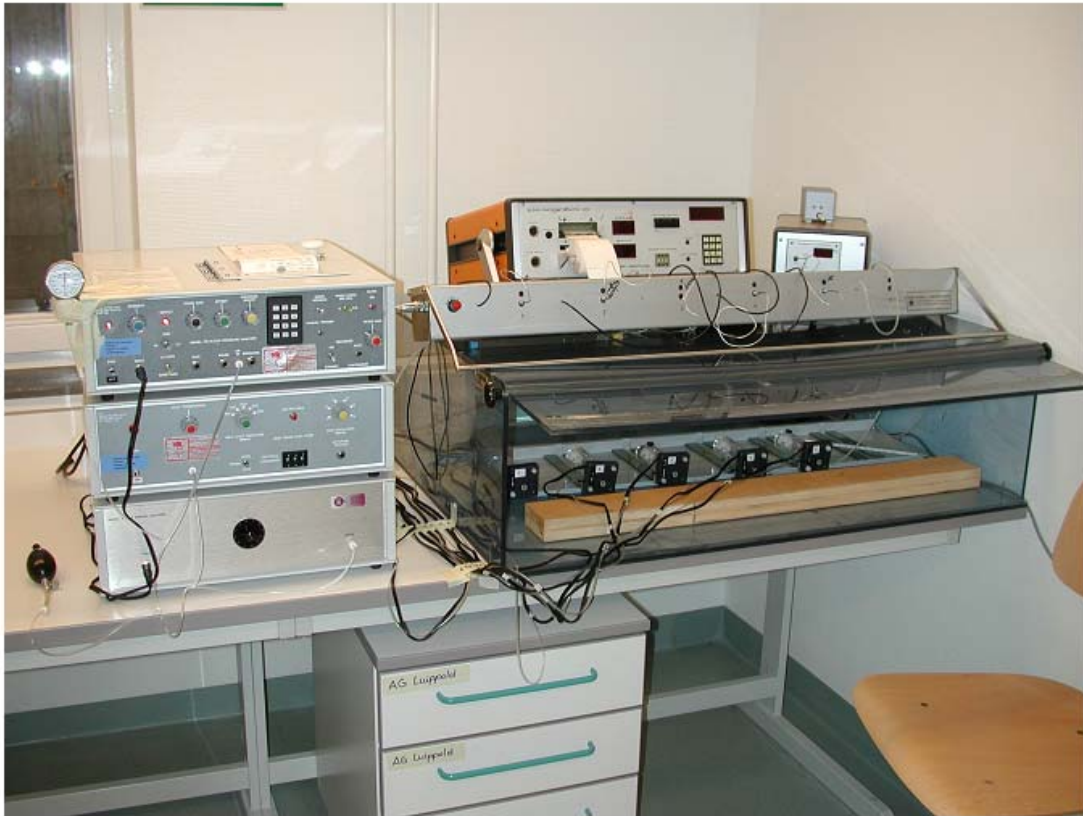
Abb. 4.2: Model 179 Blood pressure analyzer (Schwanzarterienblutdruckmessgerät) Hugo Sachs, March-Hugstetten. Der Aufbau zeigt die Acrylglasbox mit Heizung und den darin positionierten Restrainern. Ferner ist das Meßgerät, bestehend aus Pumpe, Steuerung und Auswertungseinheit, dargestellt.
