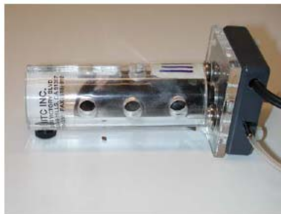
Abb. 4.1: Maus im Restrainer. Die Stellschraube ist hier so eingestellt, dass die Maus vor Beginn der Messung eine bequeme Position einnehmen kann.
