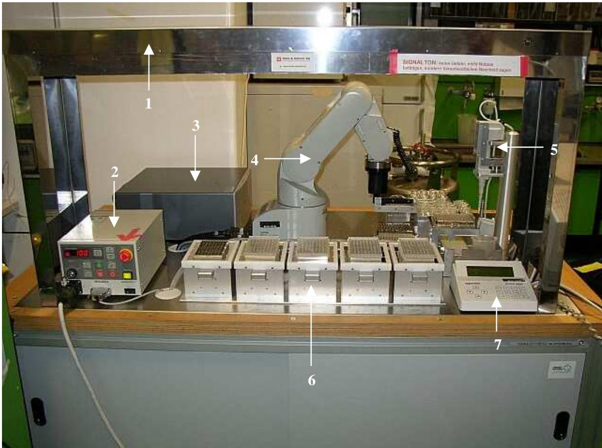
Abbildung 4.12: Aktueller Aufbau des Algentest-Automaten im Labor des Uniklinikums der RWTH Aachen. (1): Beleuchtungseinheit, (2): Roboter-Controller, (3): Fluoreszenz-Messgerät, (4): Roboterarm, (5): Liquid-Handling Station, (6): Mikrotitrationsplattenschüttler, (7): Controller der elektronischen Pipette.
