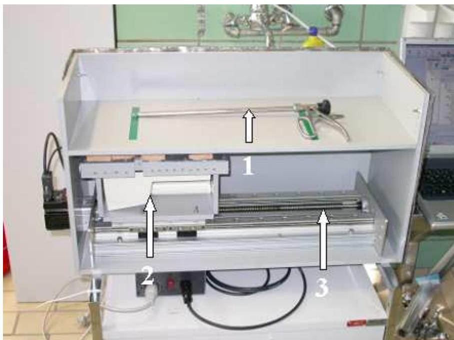
Abbildung 7.24: Mobiles System (Prototyp) zur Überprüfung der Gründlichkeit bei der Reinigung von Instrumenten der minimal invasiven Chirurgie. Medizinisches Werkzeug (1), Xenon-Detektor (2), motorgesteuerte Linearachse (3).
