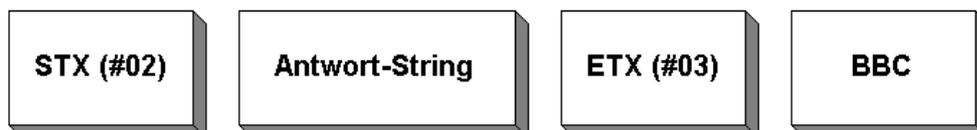
*Abbildung A1.10: Allgemeines Übermittlungsprotokoll der elektronischen Pipette EDOS 5222 bei einer Sendeaufforderung des Leitrechners mit dazugehörigem Antwort-Telegramm.*
