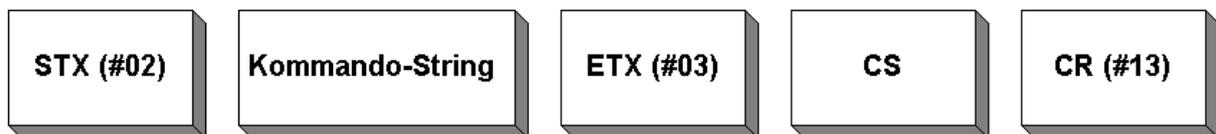
Abbildung A1.8: Allgemeines Übermittlungsprotokoll des Fluoreszenzmessgerätes SpectrFluor.
