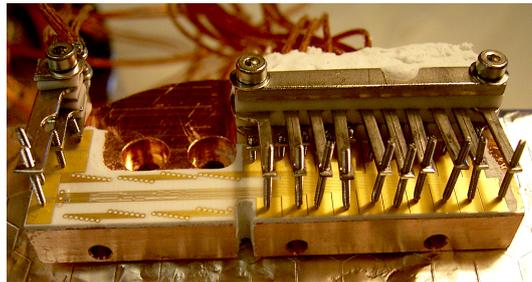
**Abbildung 5.2** Fertig montierte Mikrostruktur. Zu sehen ist eine Mikrostruktur, die auf einen Kupferblock geklebt wurde. Die elektrische Kontaktierung geschieht mit Edelstahlschrauben, die mit Federplatten auf die Kontaktpads des Chips gedrückt werden. Der in dieser Abbildung gezeigte Chip ist ein Nachfolgemodell [Gün03] des für die Experimente in diesem Kapitel beschriebenen Chips.
