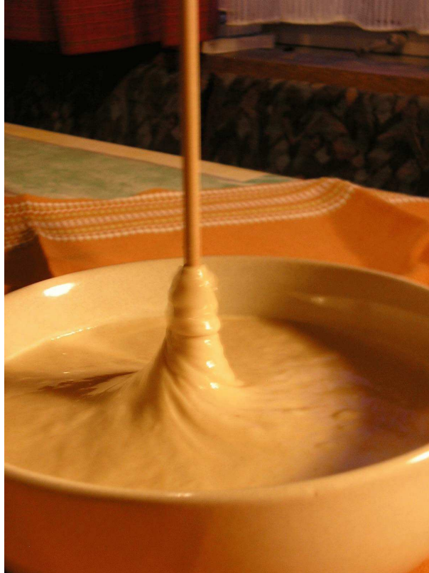
Der Weissenberg-Effekt in einem typischen polymeren Fluid *)
