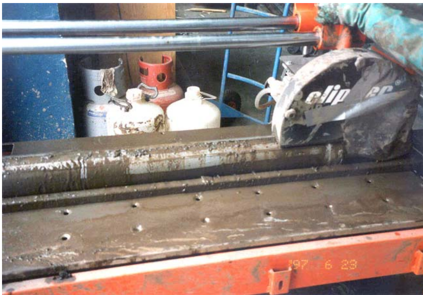
Abb. 8: Sägen der Kerne (Foto: A.R. Ashraf 1997)
