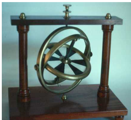
Abbildung 1: Das Gyroskop hat eine eindeutige Abfolge der einzelnen Drehachsen
