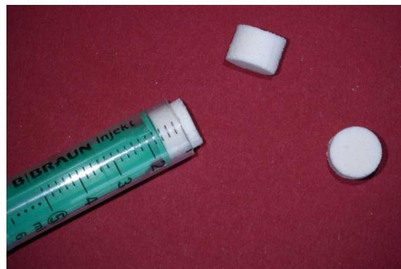
*Abbildung 3.2: Trägerherstellung, Einzelherstellung mit der Spritze*
