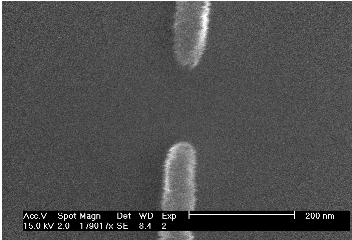
Abbildung 3.13: REM-Aufnahme eines Chrom-Splitgates. Der Abstand der Gates beträgt 158 nm, die Breite 52 nm und der Spitzenradius etwa 25 nm.
