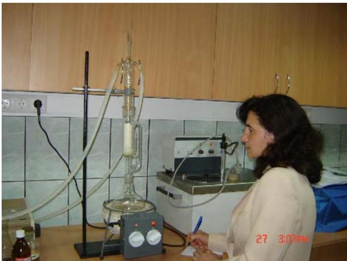
**Abb. 17 Bei der Soxhlet-Extraktion**
