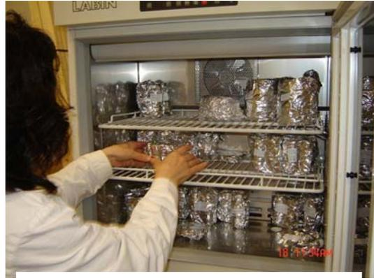
**Abb. 16 Inkubation der Keimungsversuche bei 20 °C im Dunkeln**
