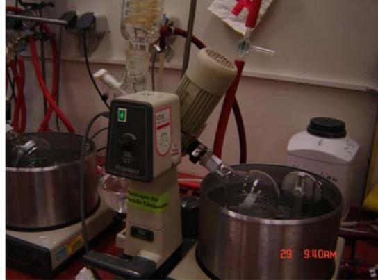
**Abb. 19 Einrotieren des Ethylacetatextrakts**
