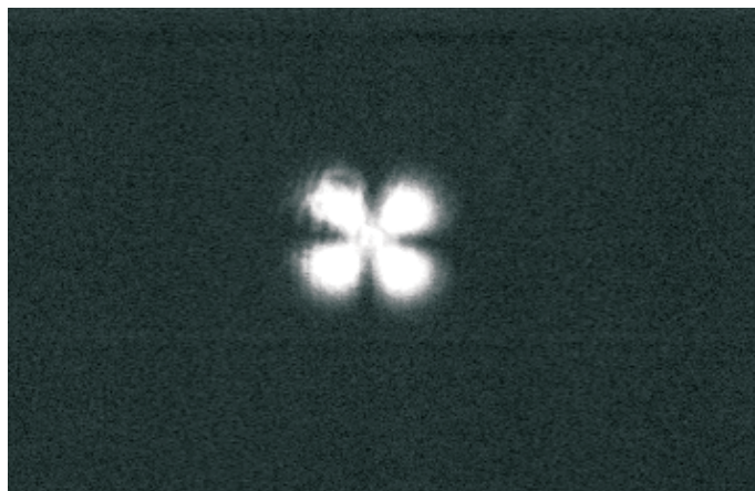
Abbildung 3.10: Aufnahme mit der CCD-Kamera der stabilisierten TEM_{11} mit TEM_{00} in der Mitte der Mode bei geringer Leistung.
