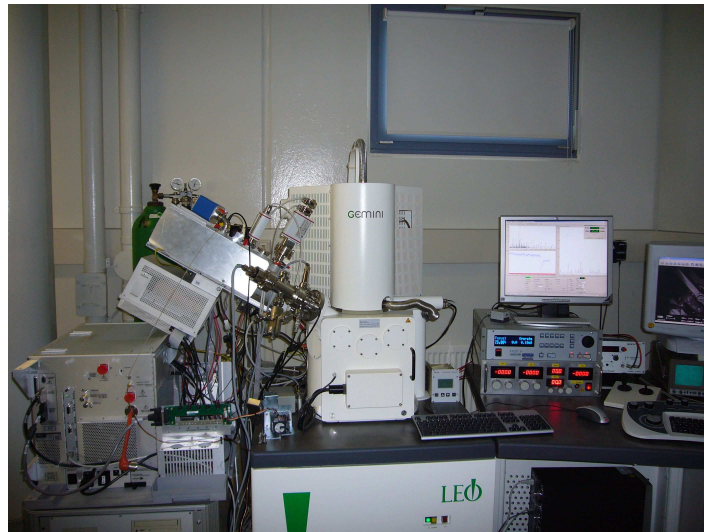
Abbildung 6.4: Integration des Ionenfallen-Massenspektrometers (links: Rezipient mit Ionenfalle und rf-Ionenleitsystem, darunter rf-Generator für Ionenfalle) an das SEM mit Argon-Gasionenquelle als Primärionenquelle, mit Elektronik
