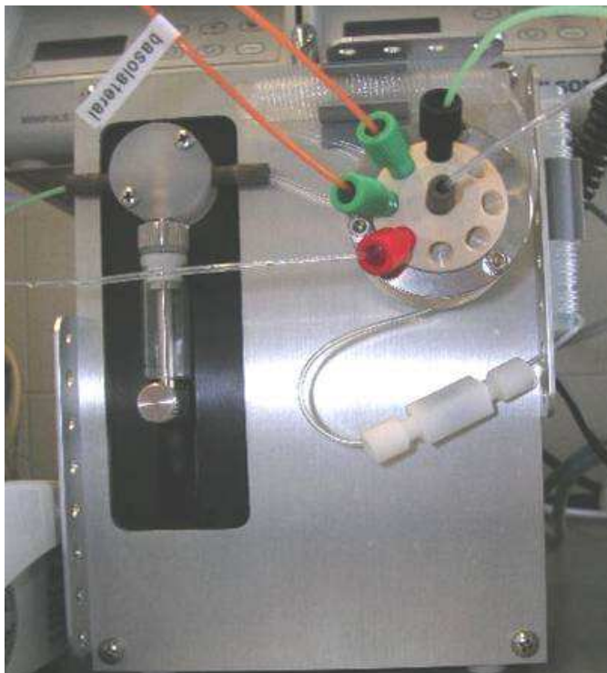
Abbildung 3-6: \mu SIA (FIA-Lab). Rechts das steuerbare 8-Kanal-Ventil, links die Kolbenpumpe zum Ansaugen und Dosieren der jeweiligen Flüssigkeiten
