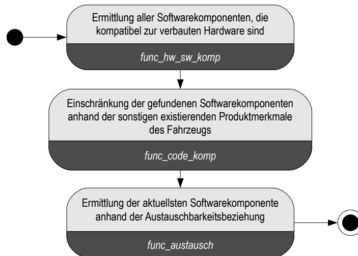
Abbildung 4.5: Ermittlung einer Softwarekomponente in der passiven Rekonfigurationsphase
