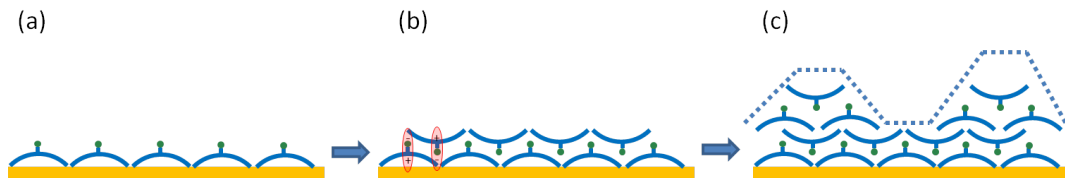
Abbildung 4.9.: Skizze des Wachstums und der Orientierung von MCIPcs auf Au(100). (a) Ausbildung der ersten Lage mit überwiegender Molekül-Substrat-Wechselwirkung. (b) Weiteres Aufwachsen durch die Dipol-Dipol-Wechselwirkung. (c) Ausbildung von Inseln durch starke Molekül-Molekül-Wechselwirkungen.
