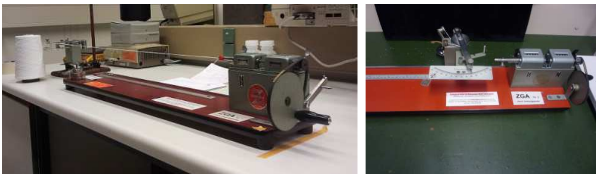
Abb. 19: Manueller Drehungsprüfer der Fa. Zweigle; Gesamtansicht (l.), Zählwer in S und Z Richtung (r.)
