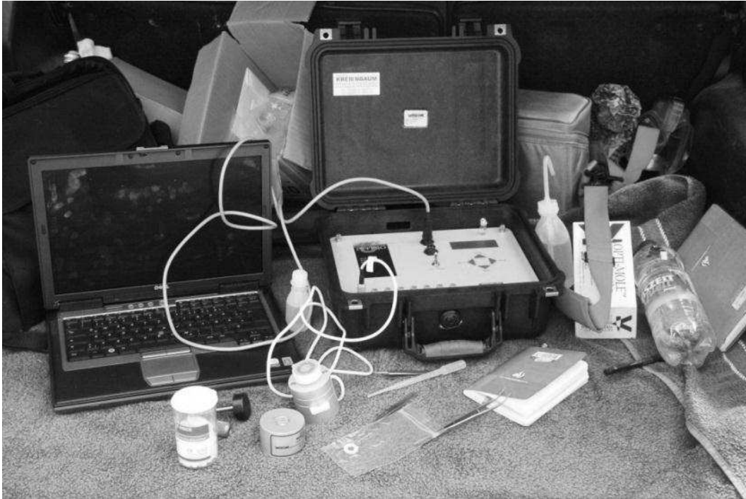
Abb. 8: Blatt-Psychrometer (Psypro) mit Messkammer und Zubehör.
