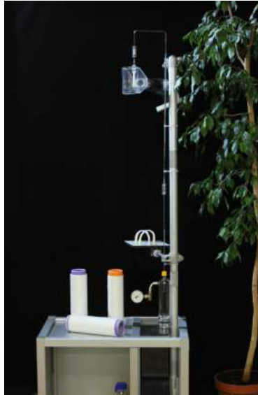
Abb. 32: Laborversuchsstand zur Untersuchung des Verdunstungsdruckes mit Quecksilber [Im Bild sind Faserspulen der Membranfaser, Glaskapillare und die Verdunstungskörper im transparenten Lufttrichter des Fönes und der Fön zu sehen. Ein Manometer erfasst den Druck an der Eintrittseite, wobei dies hier mit Quecksilber erfolgte]
