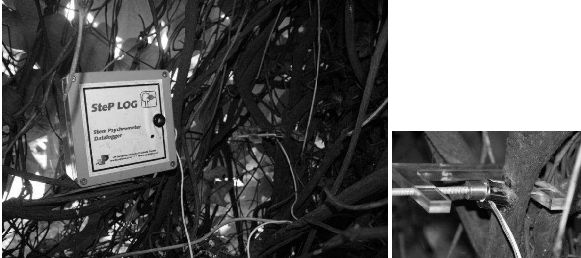
Abb. 7: Stammpsychrometer an Aristolochia macrophylla (l.) zur Aufnahme des Wasserpotentials im Xylem (r.).
