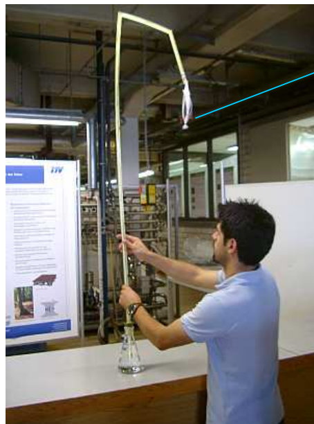
Abb. 37: Eine Variante der hergestellten Transpirationssysteme aus Membranfasern mit einer Wassertransporthöhe von 150 cm
