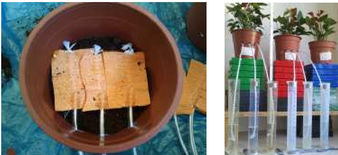
Abb. 28: Versuchsaufbau im botanischen Garten, Einsatz der Systeme im Pflanztopf (l.), Versuchsaufbau auf die Transporthöhe von 60 cm (r.)
