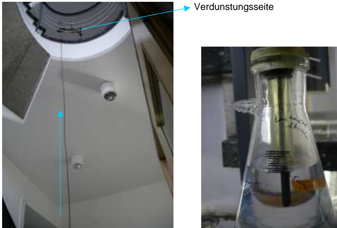
Abb. 36: Versuchsstand zur Ermittlung des Transpirationsdruckes im Treppenhaus des ITV; Versuchsstand auf einer Höhe vom 4,75 m (l.), Messung der transportierten Wassermenge in Abhängigkeit der Zeit (r.)
