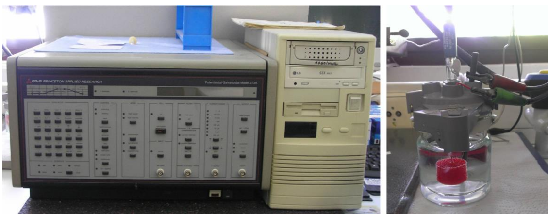
Abbildung 6: Potentiostat links im Bild. Rechts ist die Korrosionszelle dargestellt, bestehend aus einer doppelwandigen elektrochemischen Messzelle mit Drei-Elektrodenanordnung
