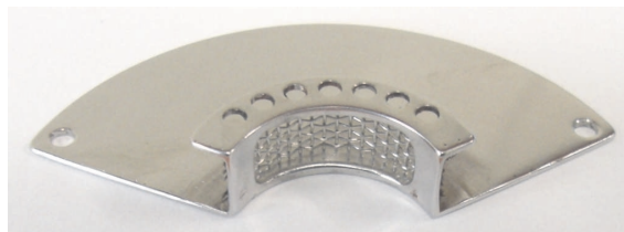
Abbildung 6.17: Halter und eigentliches Absaugnetzchen. Der Halter wird mit Hilfe eines dünnen Trovidur ® -Plättchens elektrisch isoliert an der letzten Elektrode der Objektivlinse angebracht. Um scharfe Kanten vor dem Ionenstrahl zu verbergen, wird das Netzchen auf der der optischen Achse abgewandten Seite befestigt. Die Höhe des Halters beträgt 7.6 mm.
