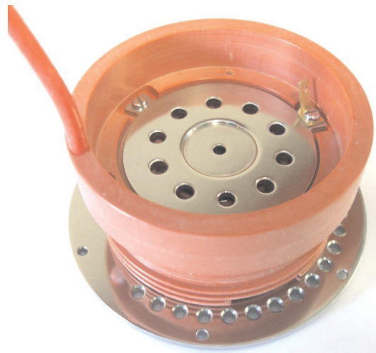
Abbildung 6.14: Montierte Objektivlinseneinheit. Zu sehen ist die erste Elektrode mit zehn großen Entlüftungsbohrungen (oben), zwei der drei Justierschrauben, die Fahne des Steckkontakts, der Isolator mit drei Rillen zur Kriechwegverlängerung, das 30 kV-Kabel zur Kontaktierung der Fokuselektrode (links) und die letzte Elektrode (unten) mit vielen kleinen Löchern nahe des Außenradius zur besseren Entlüftung des darüber liegenden Bereichs. Der Bohrungsdurchmesser der ersten Elektrode beträgt 3.0 mm.
