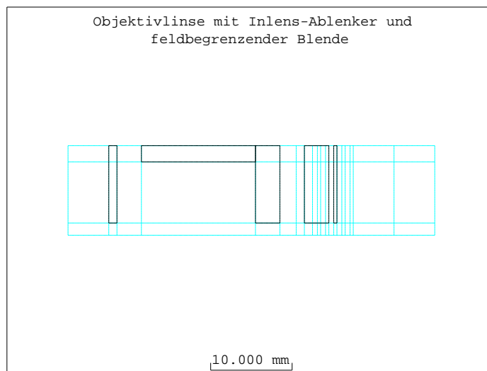
Abbildung 5.18: Simulationsmodell der Objektivlinse für einen Inlens-Ablenker mit einem Verhältnis L_{Ablenker}/d_{Ablenker} = 1 . Der Innendurchmesser der anschließenden feldbegrenzenden Blende beträgt 3.0 mm. Zu sehen ist das grobe Gitter. Die optische Achse verläuft entlang der untersten Gitterlinie von links nach rechts.
