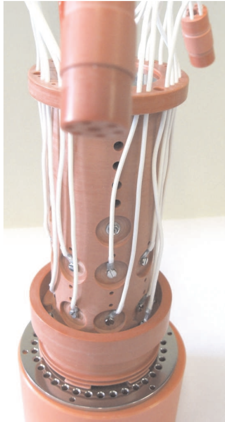
Abbildung 6.16: Verkabelung des Rasterdoppelablenkers. Zu sehen ist die Führung der 20 kV-Kabel zu den Polen des Rasterdoppelablenkers. Aufgrund der bereits justierten feldbegrenzenden Blende steht der Komplex auf einem Trovidur ® -Fuß, der in der Mitte eine entsprechende Vertiefung aufweist. Der Außendurchmesser der letzten Elektrode beträgt 84.0 mm.
