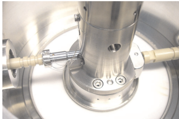
Abbildung 6.8: Blick in die auf den Kopf gedrehte Aperturblenden- und Ventileinheit. Zu sehen ist der dünne, flexible Draht, mit Hilfe dessen die Aperturblende (links) kontaktiert wird. Das Vakuumventil (rechts) hat in allen Positionen Kontakt zur Ventilgarage, so dass keine weitere Kontaktierung notwendig ist. Der Außendurchmesser des Strahlführungsrohrs beträgt 28.0 mm.
