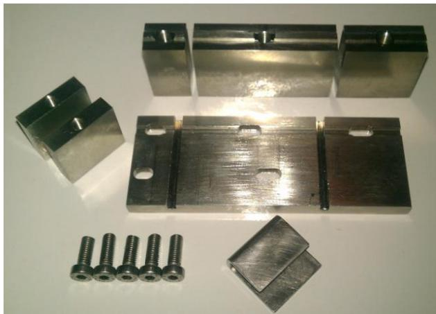
**Abb. 28: Sägevorrückung in Einzelteilen**
