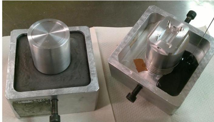
**Abb. 36: Eingießen Probenhalterung und –stempel**
