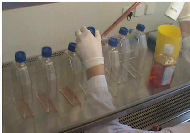
**Abb. 38: Pipetieren des Mediums**
