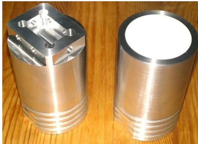
**Abb. 35: Probenhalterung und -stempel fertig**
