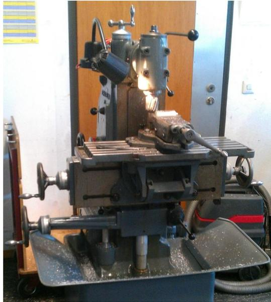
**Abb. 25: Schaublin Universalfräsmaschine**
