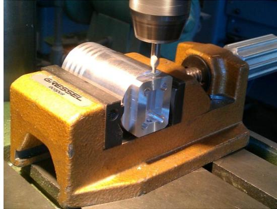
**Abb. 34: Einbringen der Gewindebohrungen**
