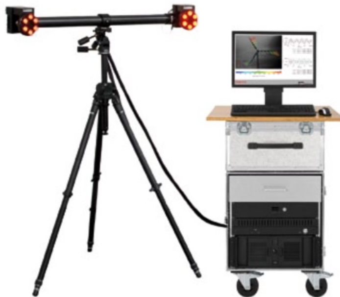
Abbildung 2.6.: Die PONTOS 5M besteht aus zwei Kameras und einem Rechner [Vgl. 96].
