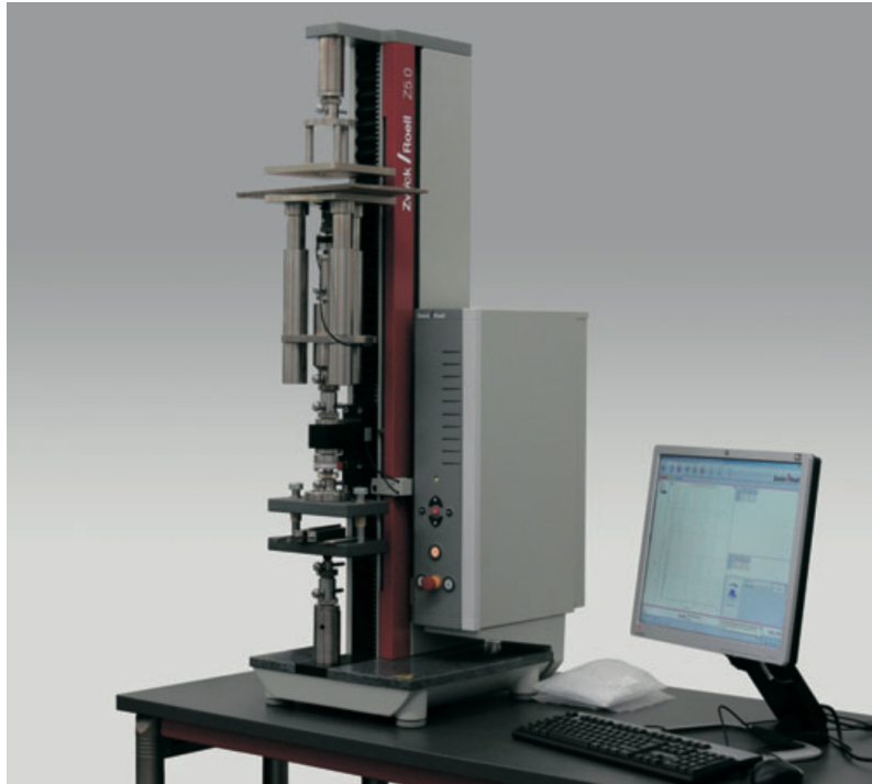
Abbildung 2.4.: Die Materialprüfmaschine Zwicki-Line Z2.5 bestand aus einem Lastrahmen und einem Rechner. (Hier ist die größere Version Z5.0 abgebildet) Aus [Vgl. 95, S.1]
