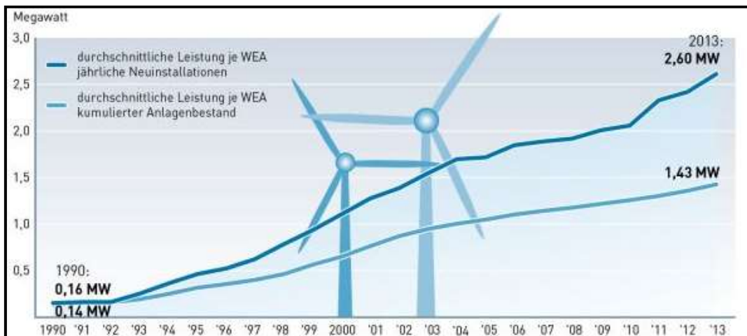
Abbildung 14: Entwicklung der durchschnittlichen Leistung von Windenergieanlagen 1990-2013 (Quelle: AEE - Agentur für Erneuerbare Energien 2014, verändert)
