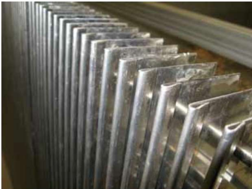
Abbildung 27: Fischschonender Rechen nach Hassinger (Quelle: Hassinger o.J.)
