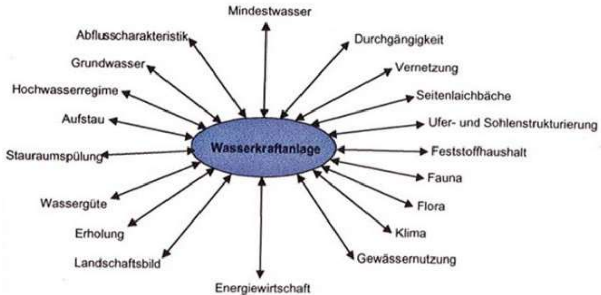
Abbildung 16: Wechselwirkungen zwischen Wasserkraft und Umwelt. (Quelle: UM 2010, S. 36)
