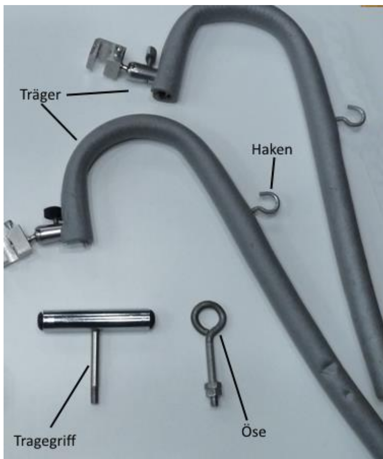
Abbildung 24: Schulranzennachbildung, an der die Gewichte über eine Öse an den Haken der Träger eingehängt werden konnte. Dies repräsentierte die beidseitige Trageweise. Für die Messungen der einseitigen Belastung wurden die Gewichte auf den Tragegriff aufgeschraubt.
