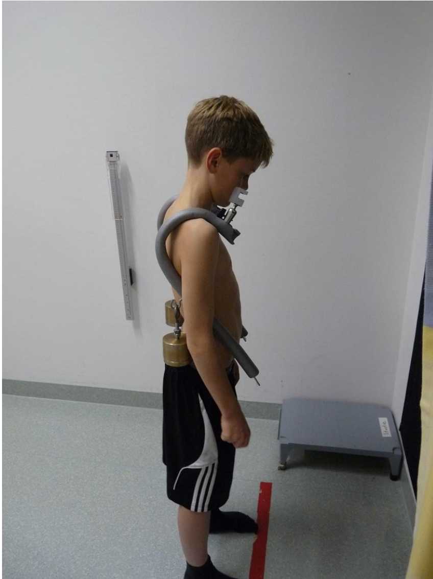
Abbildung 25: Schulranzennachbildung mit eingehängten Gewichten in der Seitansicht
