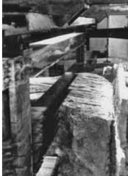
Abb. 12: Ein Block bei der Bearbeitung im Sägegatter.
