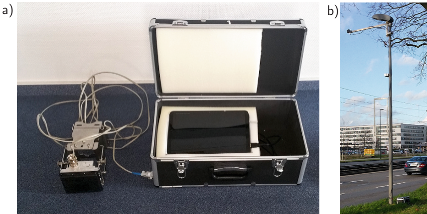
Abbildung 4.1: Radarmessung an der Völklinger Straße in Düsseldorf: a) Radarsensor mit Messkoffer, b) mit Ausleger an Leuchte installierter Radarsensor.
