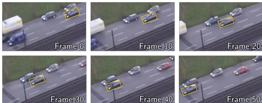
Abbildung 4.6: Supervised-Tracking eines Fahrzeugs über 50 Frames bzw. 2 Sekunden.
