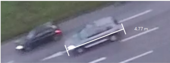
Abbildung 4.17: Messung der Fahrzeuglänge eines Porsche Cayenne Typ 9PA (Herstellerangabe 4,78 m).
