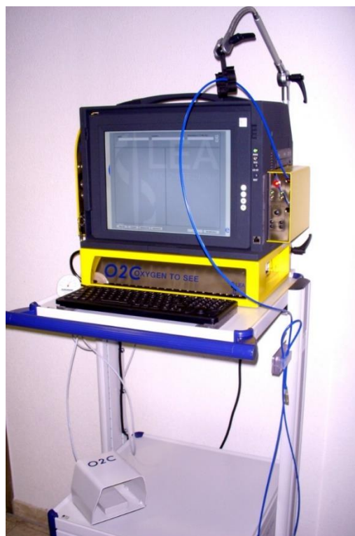
Abbildung 12 Das O2C®-Gerät der Firma LEA Medizintechnik, Gießen. Zu sehen sind der Monitor mit Rechner, die Tastatur, die Sonde und der Fußschalter.
